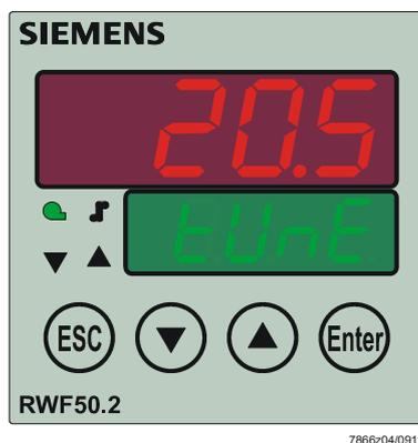
Figura 19: Indicación de la función de autoajuste
